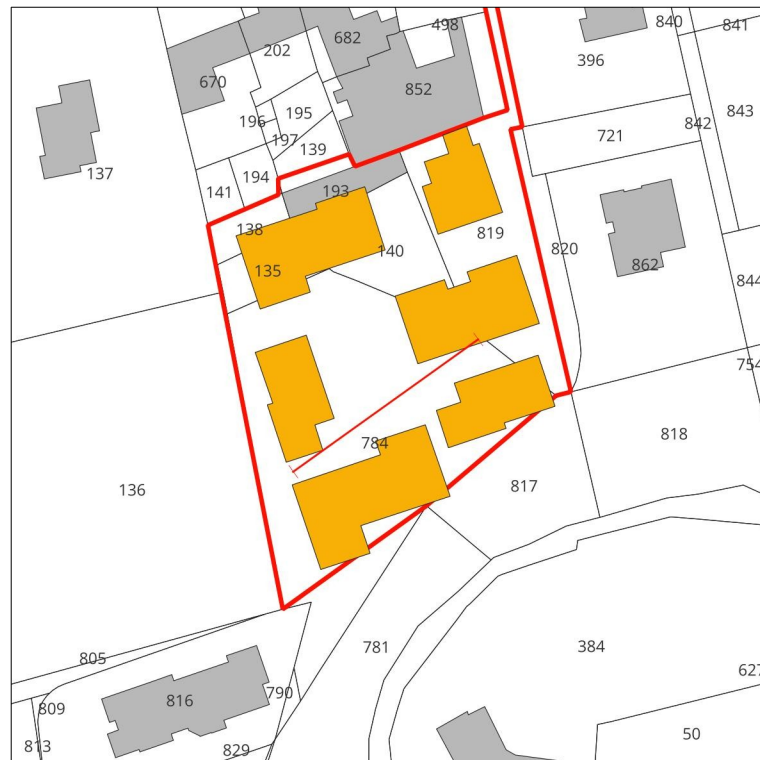
Fig. 6: localizzazione prova sismica MASW – scala 1:1500. In arancione i fabbricati in progetto.
